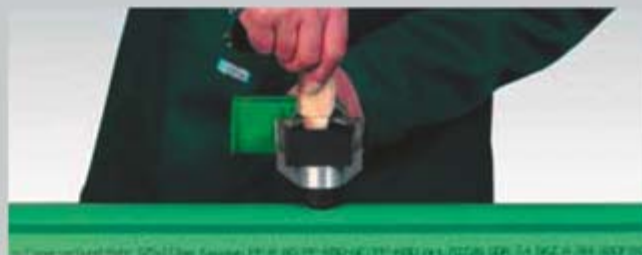
Alat za zavarivanje umeće se u stijenku cijevi...
