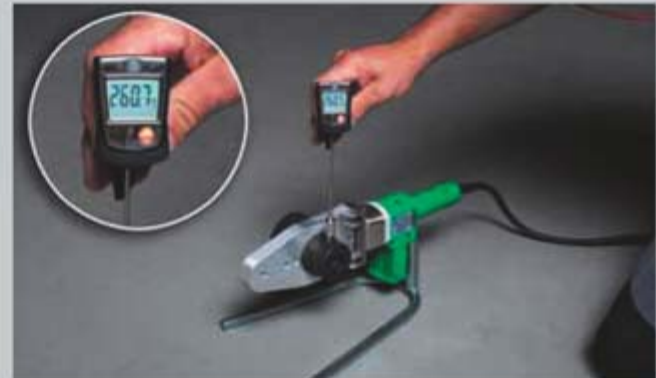
Mjerenje temperature na aquatherm aparatu za ručno zavarivanje (800 W)
