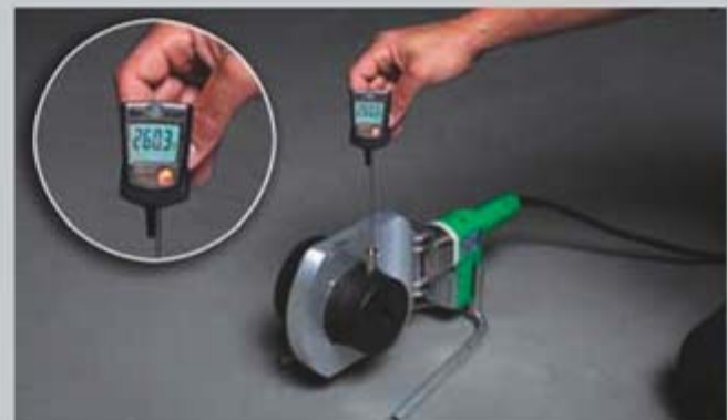
Mjerenje temperature na aquatherm aparatu za ručno zavarivanje (1400 W)
