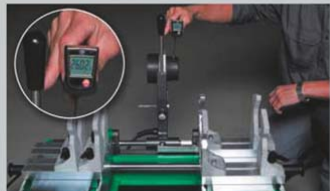
Mjerenje temperature na aquatherm stroju za zavarivanje
