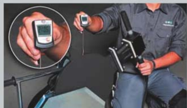
Mjerenje temperature na aquatherm stroju za zavarivanje
