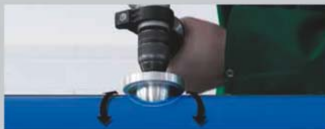
Uklanjanje sloja s barijerom za kisik kod aquatherm blue OT cijevi
